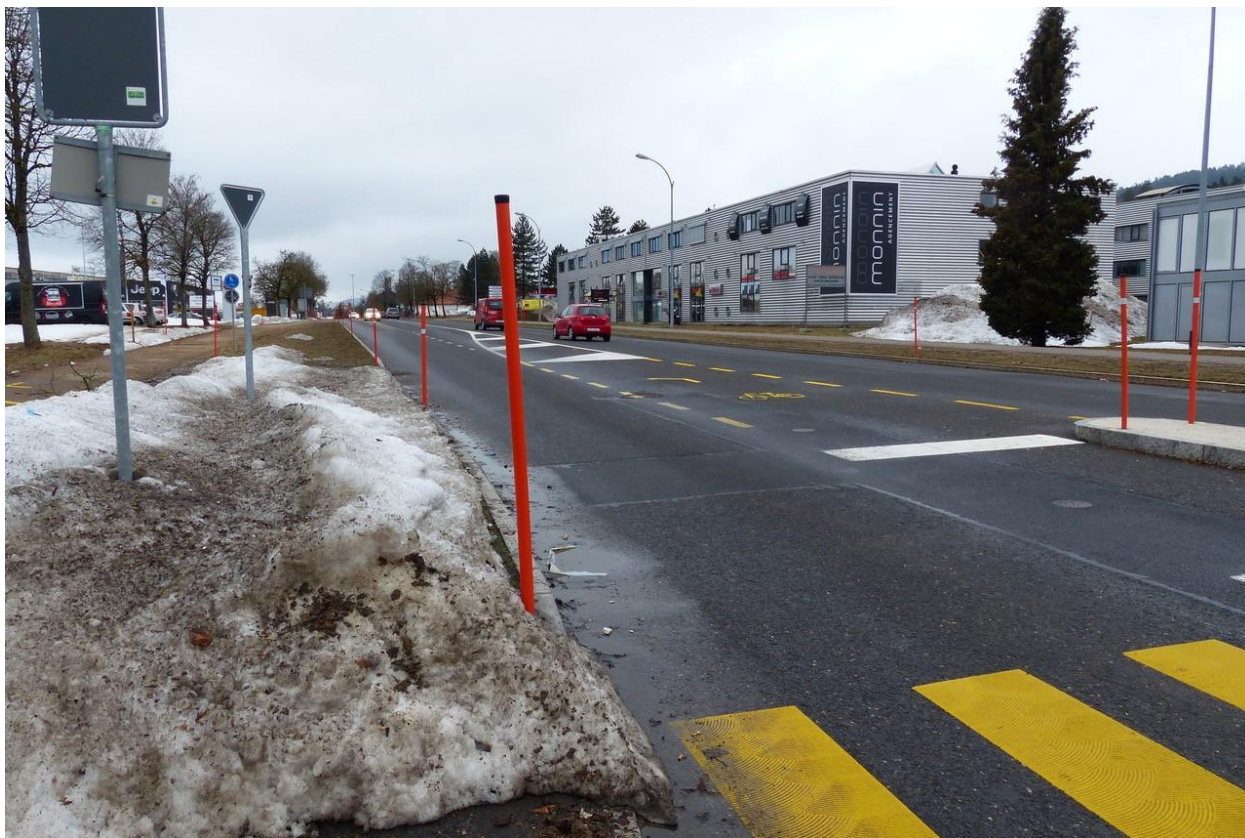
Figure 25 : Suite de l'image précédente. Après avoir emprunté le giratoire pour tourner à gauche, le cycliste doit à nouveau faire une manœuvre et traverser la chaussée à l'aide de la présélection cyclable pour finalement arriver sur la piste cyclable.
